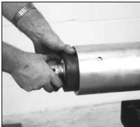
FIG. 77: INSTALL CONTROL STUD
